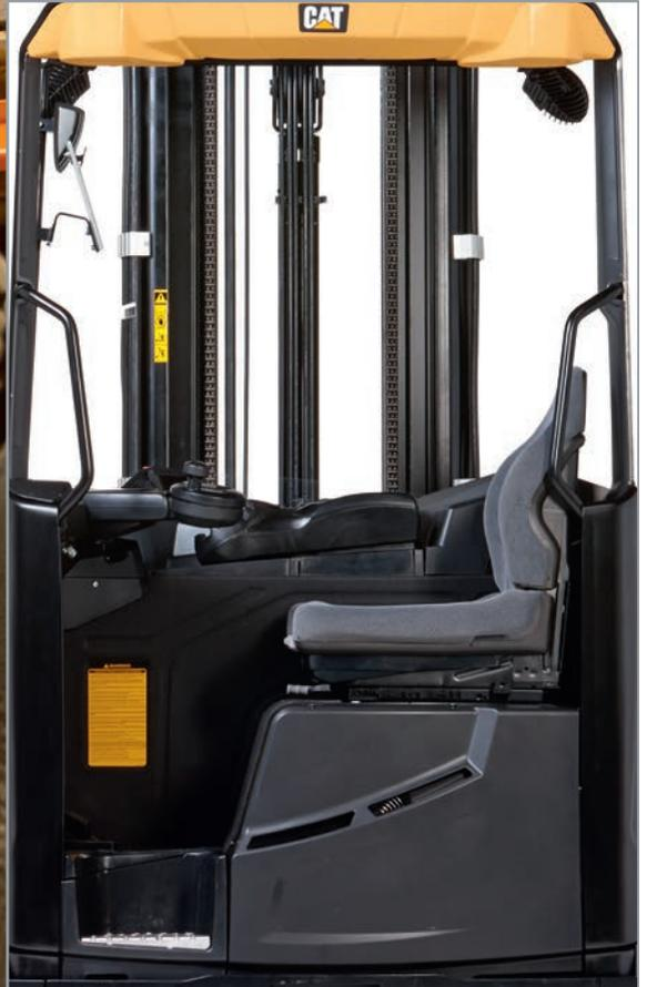
Visibilidad del operador muy despejada (izquierda y abajo), con cables y mangueras cuidadosamente colocados y los cilindros hidráulicos incorporados al perfil del mástil (izquierda).
